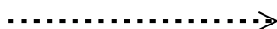
Figura 5.3: Costrutto per definire l'associazione di Data Object o Data Store a un'attività o un evento
